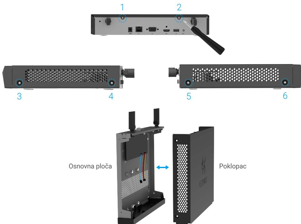
2. Povežite podatkovni kabl i strujni kabl NVR-a koji su već umetnuti u PCB sa HDD-om (prodaje se odvojeno) redom.
